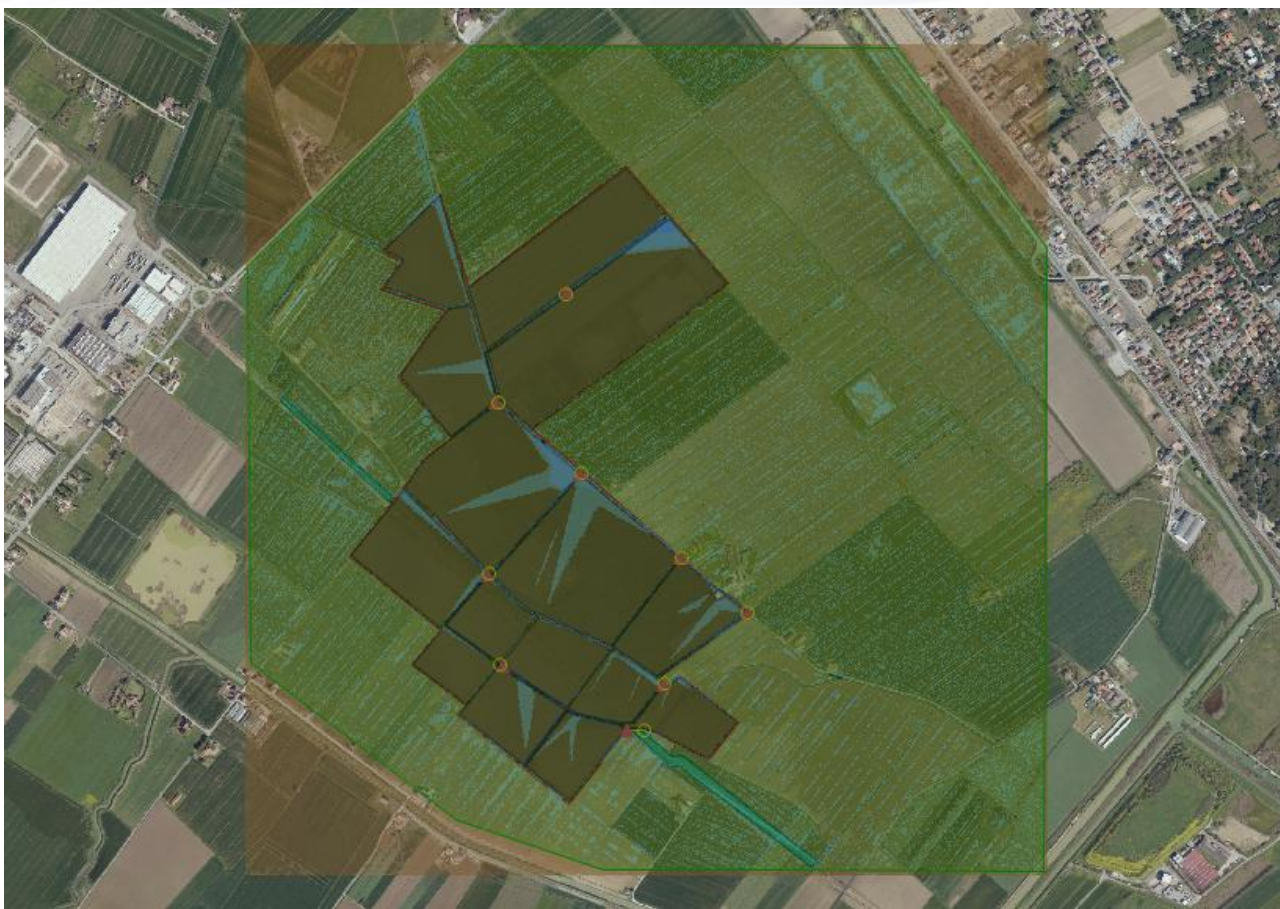
Figura 18 - Vista dei risultati della simulazione per TR50 nello stato di progetto. I valori inferiori dei tiranti sono di 1 cm (azzurro chiaro).
