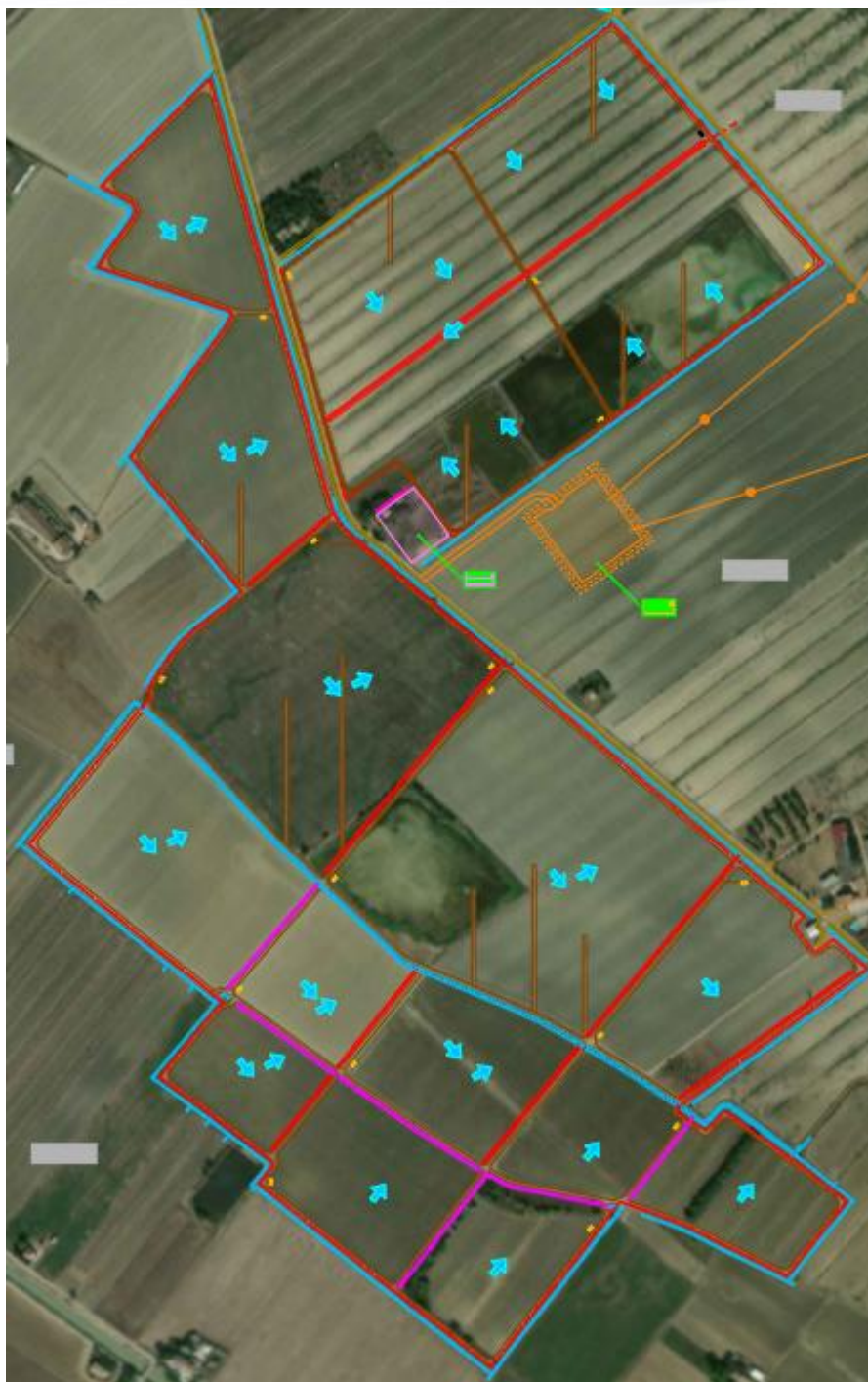
Figura 2 - Schema dell'assetto di progetto del reticolo idraulico di scolo nel progetto
